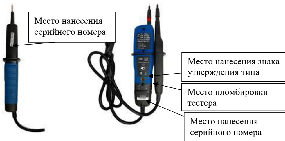
Рисунок 1 – Общий вид тестеров напряжения DT с указанием места пломбировки от несанкционированного доступа, места нанесения серийного номера и знака утверждения типа
